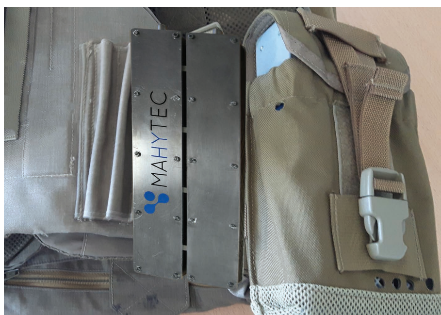
Positionnement Réservoir et Système PAC sur un Gillet de fantassin
